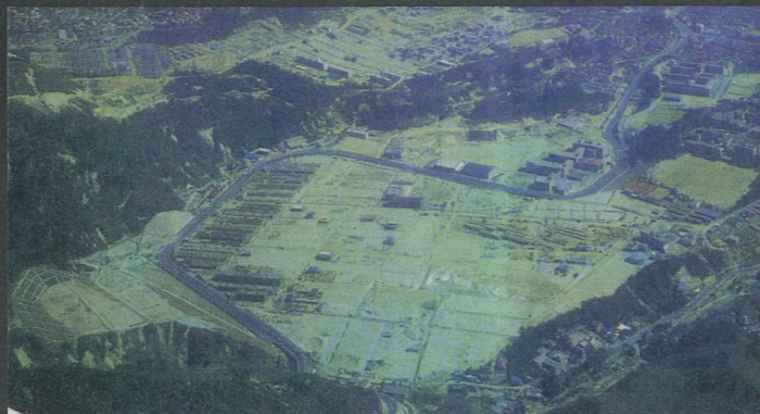
摩耶埠頭の埋め立てに使われたのは鶴甲山の土砂は地下のベルトコンベアで運ばれ「山、海へ行く」と反響を呼んだ。造成中の鶴甲団地(昭和42年)
