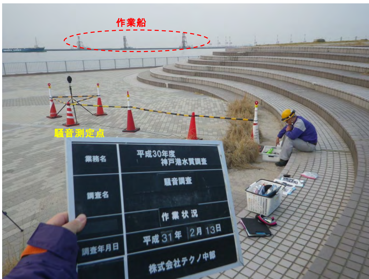
図Ⅱ-2-2 騒音調査点から見た工事作業状況
