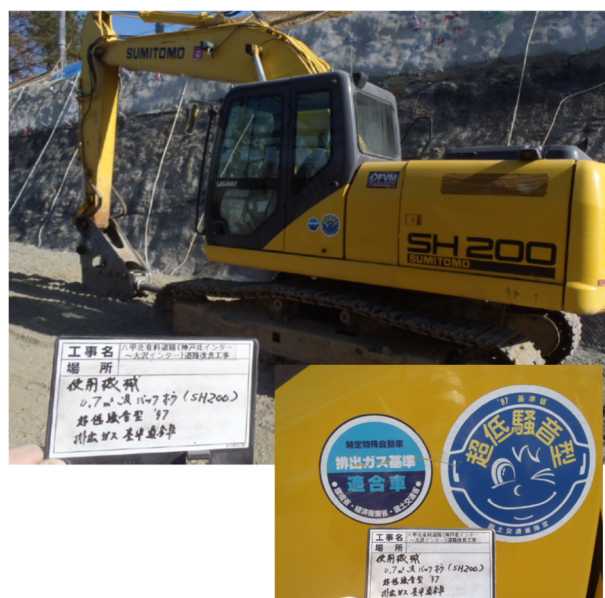
図 4-4 排出ガス対策型建設機械の使用
